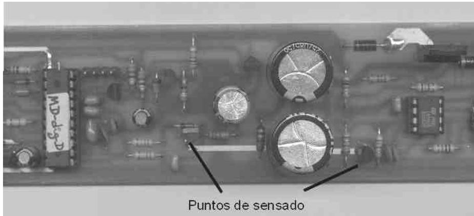
Figura 8; puntos de toma de temperatura en el balasto.
