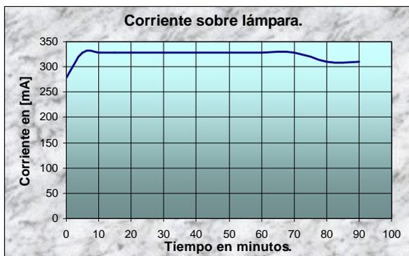
Figura 13; Gráfica de corriente sobre lámpara.
